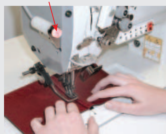
Maschine verursacht Fehlstich -> Maschine stoppt automatisch -> Signaltaster leuchtet auf -> Maschine ist nicht mehr betriebsbereit
